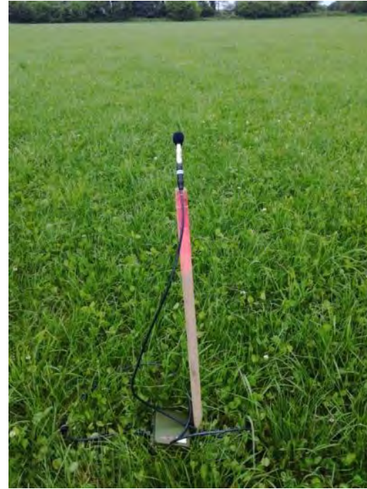
Figure 281 : Enregistreur d'ultrasons de type SM4bat (Wildlife Acoustics). Source : Althis.
