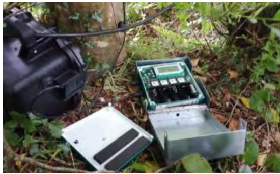
Figure 283 : Enregistreur d'ultrasons de type SM2bat+ (Wildlife Acoustics). Source : Althis.
