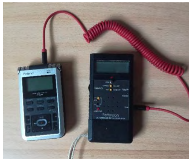
Figure 279 : Détecteur ultrasons Pettersson D240x (Pettersson Elektronik) et enregistreur Roland-R05 (Roland). Source : Althis.
