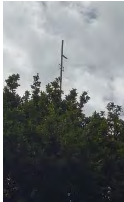
Figure 285 : Photo 5 - Mât d'écoute posé en canopée à Bourbriac. Source : Althis.
