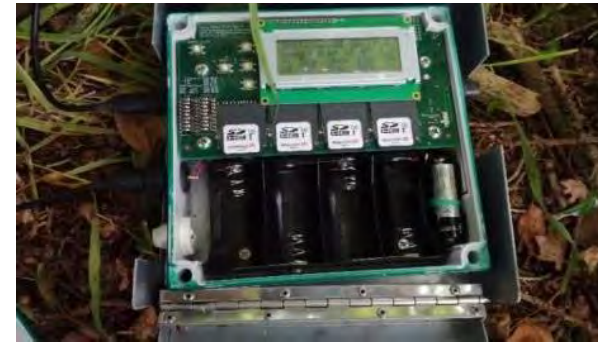
Figure 284 : Détail de l'enregistreur SM2bat+. Source : Althis.
